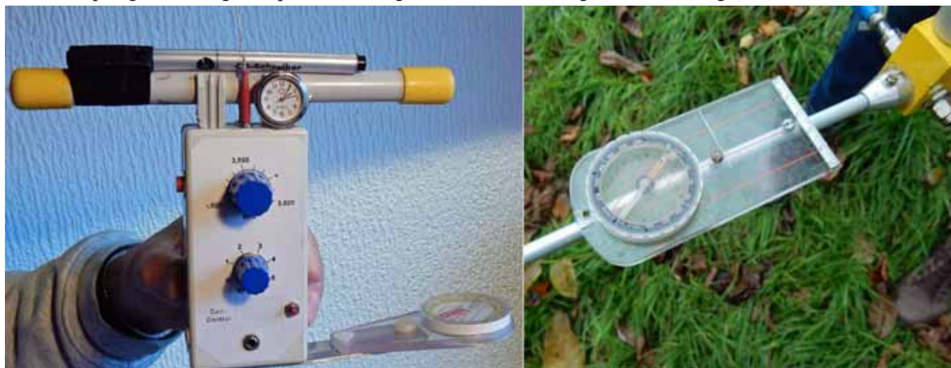
55. Het kompas gemonteerd aan een 80 m en aan een 2 m ontvanger.
