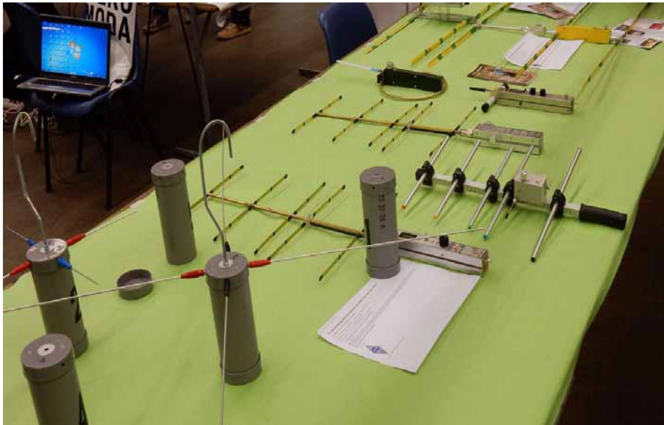
4. Diverse ARDF apparaten. Van onder naar boven: 70 cm en 2 m zender (met antennes) en daaromheen drie zenders zonder antenne, drie 70 cm ontvangers, twee 80 m ontvangers en twee 2 m ontvangers. De binnenkant van de 2 m zender is te zien op afbeelding 31 op pagina 19.
