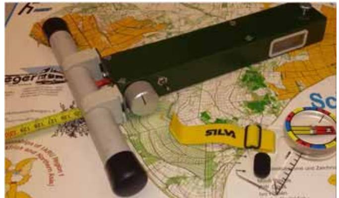
27. De complete FJRX85 met ferriet antenne gebouwd met het bouwpakket van DL8UWE.
