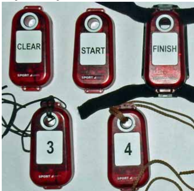
12. Diverse SI-stations: één voor bij de start, voor bij de finish, voor bij de vossen en één die een deelnemerschip wist.
