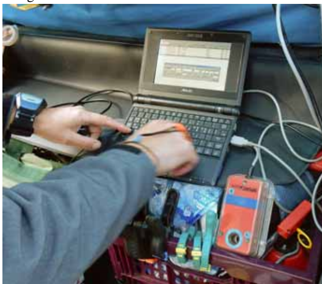
13. PC en SI-station in de kofferbak van de auto van PE5EDW (sk) voor de aanmelding en de uitlezing van de chips.
