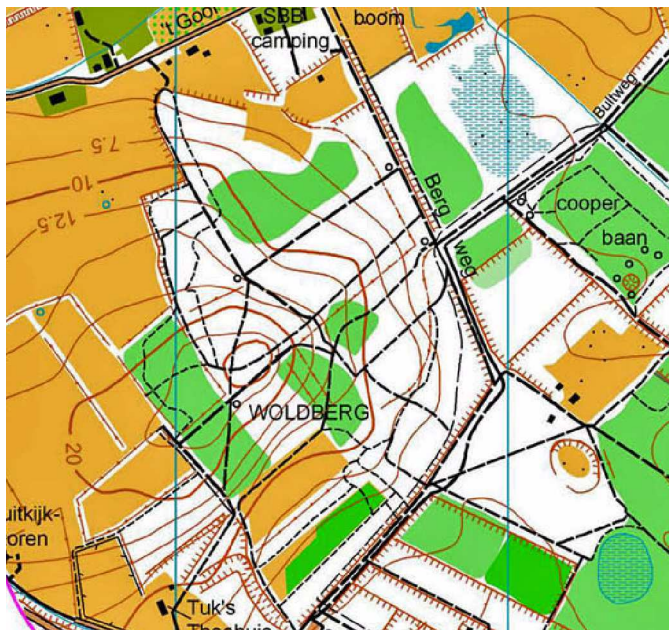
34. Een deel van de OL-kaart van het gebied rond de Woldberg bij De Bult (boven Steenwijk). Hier is functie van de hoogtelijnen goed te zien. Ze liggen op 2,5 m hoogteverschil ( H=2,5m ). Hier wordt één keer per jaar een ARDF wedstrijd gehouden.
