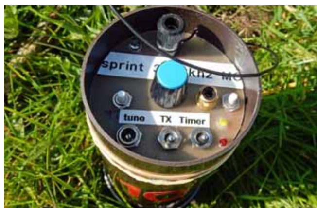
47. Het instel paneel in een 80 m ARDF Sprint zender. Het deksel is verwijderd om toegang te krijgen. Voor enige tegen-capaciteit zit aan de onderkant een metalen pen welke in de grond wordt gestoken.
