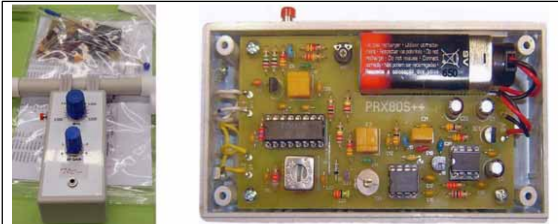
20. Links het bouwpakket en rechts het binnenwerk van de compleet gemonteerde ontvanger.
