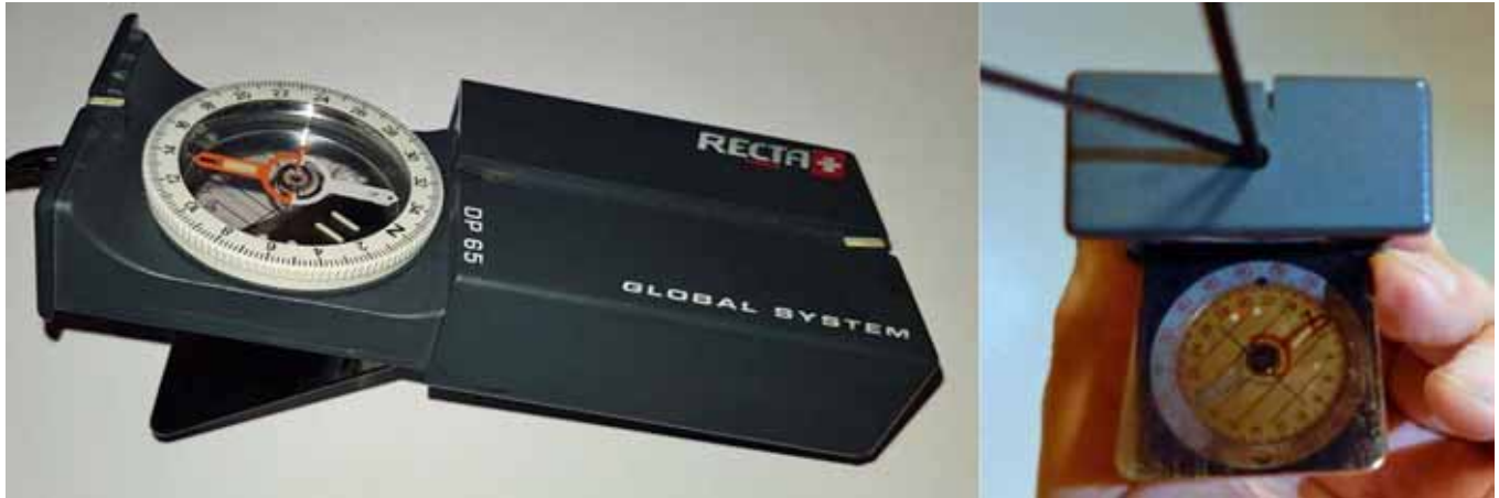
56. Spiegelkompas. Rechts het gebruik ervan tijdens een peiling.
