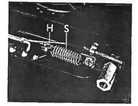
Fig. 20. Replacing the thermal fuse
