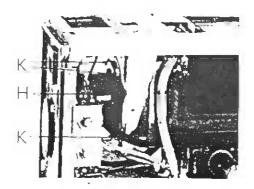
Fig. 23. Positioning the c.r.t.
